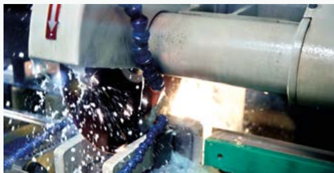
Kapning av skenstyrning.
