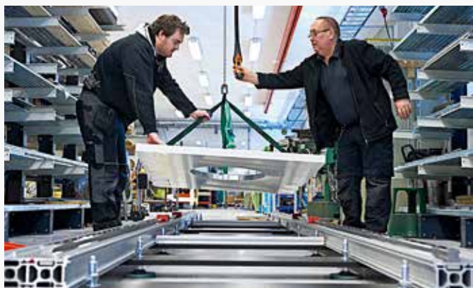
Montering av 17 meter robotåk i en av våra "lång-gångar". Skenstyrningar, aluminiumprofiler, remmar, servoväxel m.m.
