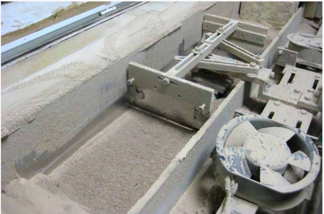
Dammtester i laboratorium. Tester görs dels i virvelkammare men även helt nere, begravt i dammet.
