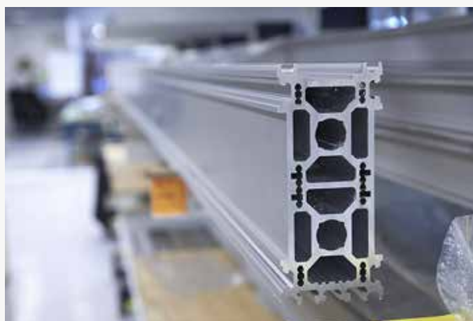
En av våra egna aluminiumprofiler speciellt framtagna för linjärenheter.
