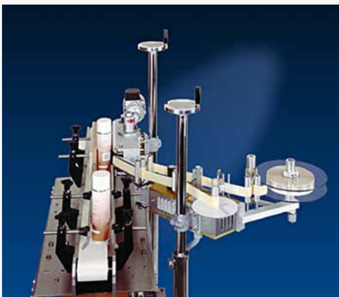
Ytterligare en applikatorutrustning som anbringar etiketterna på "rätt plats", höjdläget justeras enkelt med stabila E-ställenheter.
