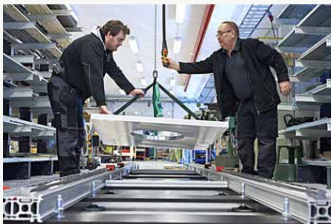
Montering av 17 meter robotåk i en av våra "lång-gångar". Skenstyrningar, aluminiumprofiler, remmar, servoväxel m.m.
