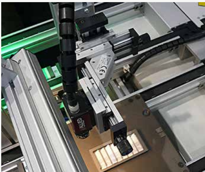
RK Compact i en treaxlig kombination, ställer in avsökningsutrustning/ vision, stabilt och enkelt med läsbart läge.
